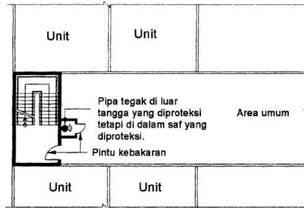
Gambar 4.3.6.(3). – Pipa tegak di luar tangga yang diproteksi
